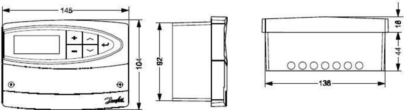
При монтаже на щите (кодировый номер 087B1249), толщина не должна превышать 5 мм
