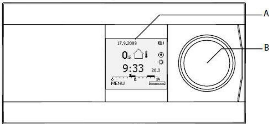
Графический монохромный дисплей (А) отображает всю информацию о значениях температуры и используется для настройки параметров. Возможны различные варианты отображения информации. Навигация, поиск и выбор параметра осуществляется с помощью многофункциональной кнопки (В).
